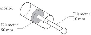
(d) Calculate the **effective** area of the piston when the piston rod is **instroking**.
