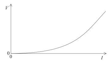
¿Cuál de las siguientes es correcta en relación con la resistencia del filamento y su temperatura, a medida que la corriente aumenta en el filamento?
