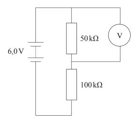
Se conecta un voltímetro ideal entre los extremos del resistor de  $50\,k\Omega$ . ¿Cuál de las siguientes es la lectura del voltímetro?
