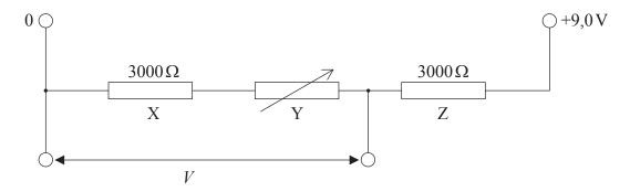
Les résistances X et Z sont des résistances fixes d'une valeur de  $3000\,\Omega$ . La valeur de la résistance Y peut être ajustée entre zéro et  $3000\,\Omega$ .
