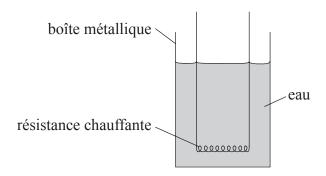
L'eau bout à un débit constant. La masse d'eau vaporisée par unité de temps est  $M_1$  pour une puissance de chauffe  $P_1$ . Lorsque la puissance de chauffe est augmentée à  $P_2$ , la masse d'eau vaporisée par unité de temps est  $M_2$ . Les pertes de chaleur dans l'atmosphère ne sont **pas** négligeables.
