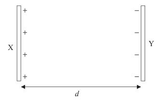
La cuantía de la carga sobre cada placa es la misma. Se acelera una partícula de carga +q, a partir del reposo, desde la placa X hasta la placa Y. La energía cinética de la partícula cuando alcanza Y es  $E_C$ .
