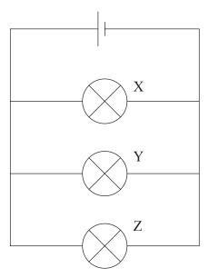
La célula tiene resistencia interna despreciable. El filamento de la bombilla Y se rompe de modo que su resistencia se hace infinita.
