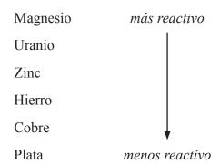
Se añadieron cantidades en exceso de cada metal a una solución de sulfato de cobre(II) 1,00 mol dm<sup>-3</sup>. Se midió la variación de temperatura y se calculó la variación de entalpía.
